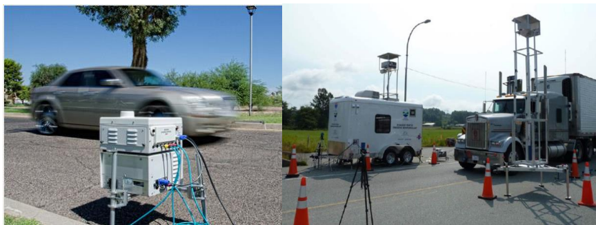
Figura 10.13: Equipo RSD en la vía pública
